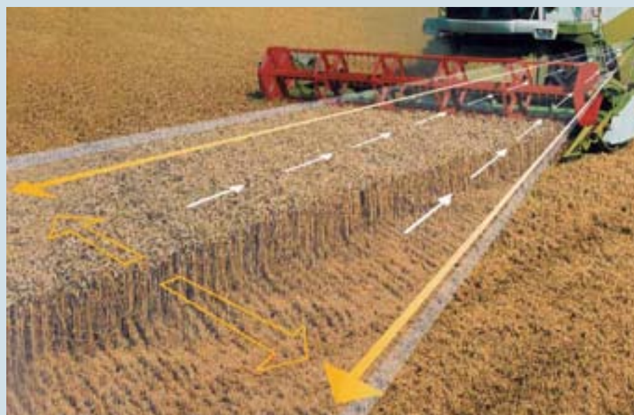
Automatische Lenksysteme steigern die Arbeitsqualität und die Flächenleistung. Überlappungen oder Auslassungen werden vermieden und der Kraftstoffverbrauch gesenkt.
